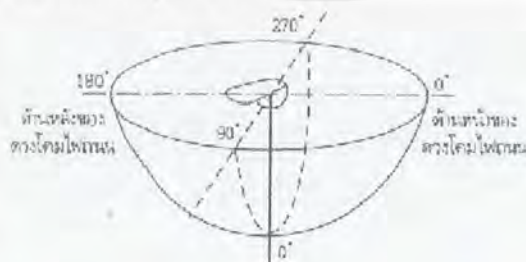
รูปที่ 2.34 การแบ่งมุมต่างๆ ที่ใช้อ้างอิงกับตารางข้อมูลแสงสว่างของดวงโคมไฟถนน
