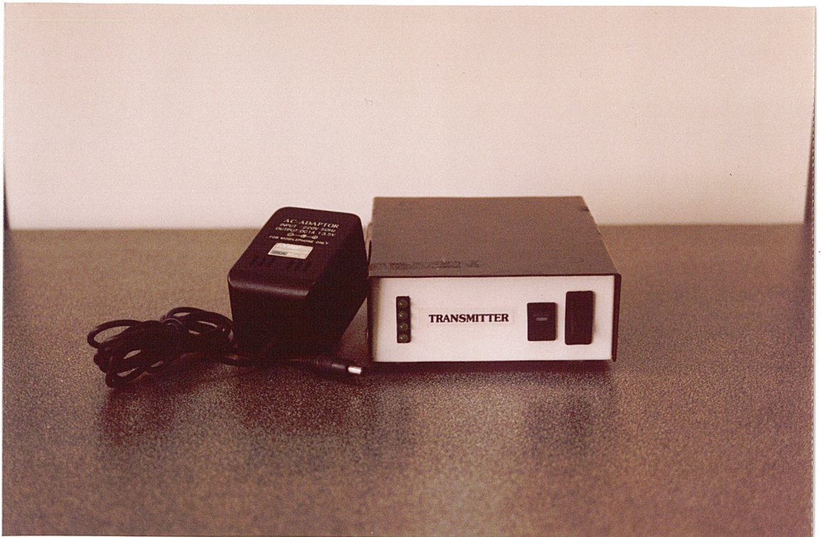
รูปที่ 4.3 เครื่องมอดูเลตสัญญาณด้วยความถี่พาหะ 24 เมกะเฮิรตซ์
