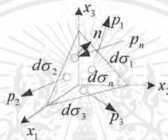
รูปที่ 2.22 ความเค้นบนพื้นผิวของทรงสี่หน้า
