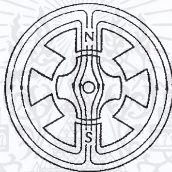
ภาพที่ 3.2 แสดงตำแหน่งสมดุขั้ว เมื่อเฟสใดเฟสหนึ่งของสเตปมอเตอร์ถูกกระตุ้น
