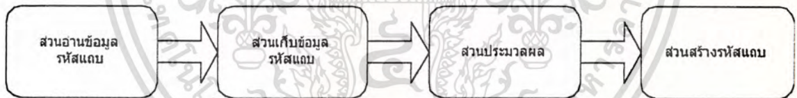
รูปที่ 3.11 แสดงโครงสร้างของส่วนอ่านรหัสแถบ
