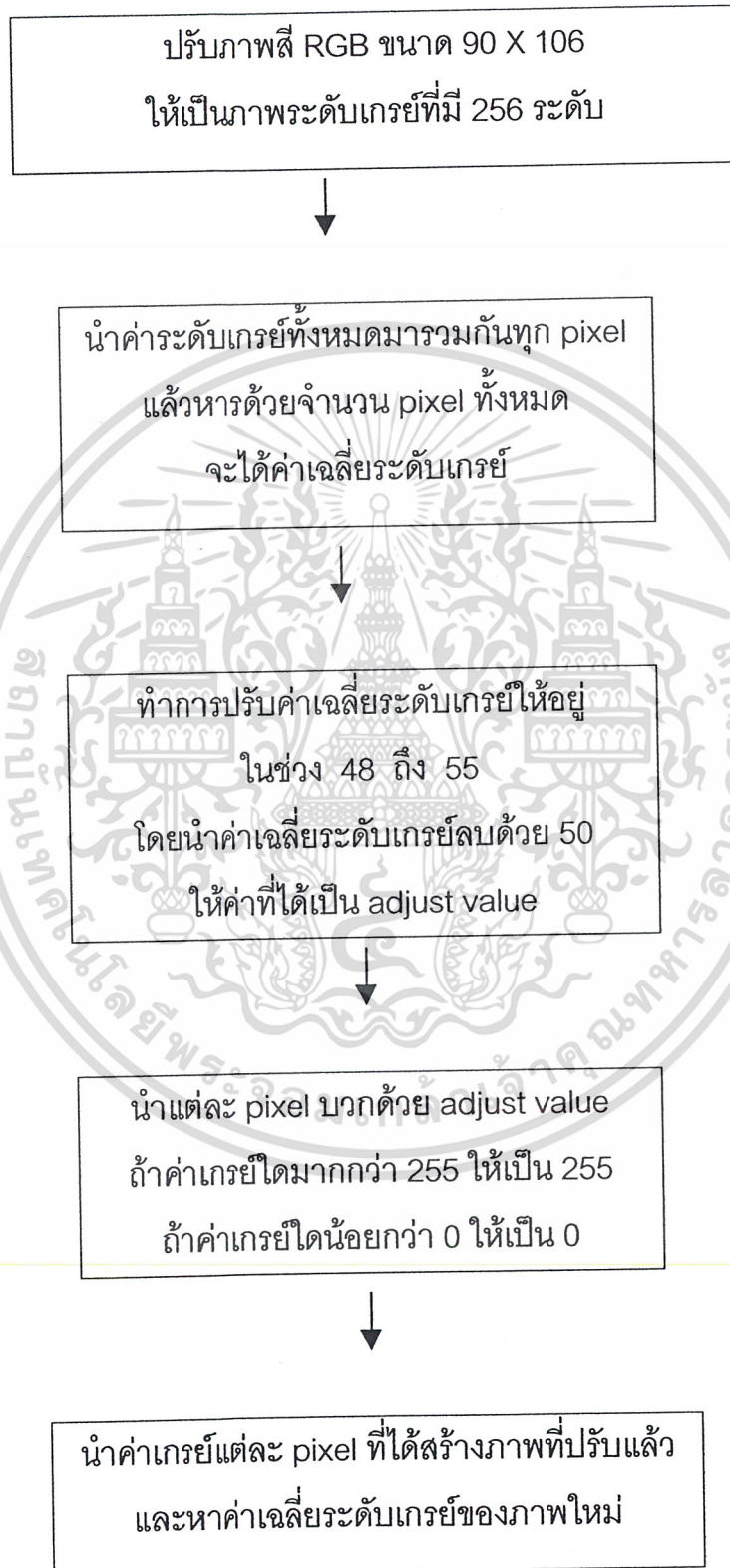
รูปที่ 3.13 Block Diagram การปรับค่าเฉลี่ยระดับเกรย์แบบเชิงเส้นของภาพ
