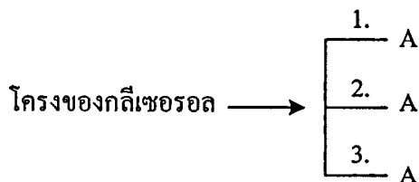
ภาพที่ 2.1 ตำแหน่งพันธะเอสเทอร์ในไตรเอซิลกลีเซอรอล คือ 1,2,3 A= กรดไขมัน
