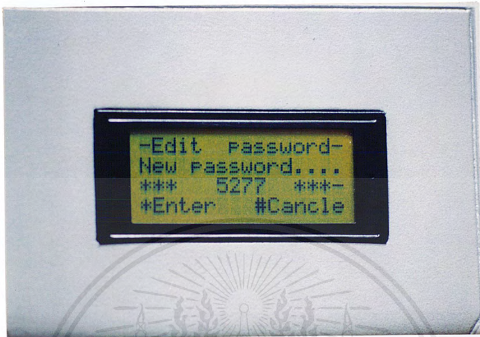
รูปที่ 4.10 หน้าจอแอลอีดีการเปลี่ยนรหัสผ่านจำนวน 4 หลัก
