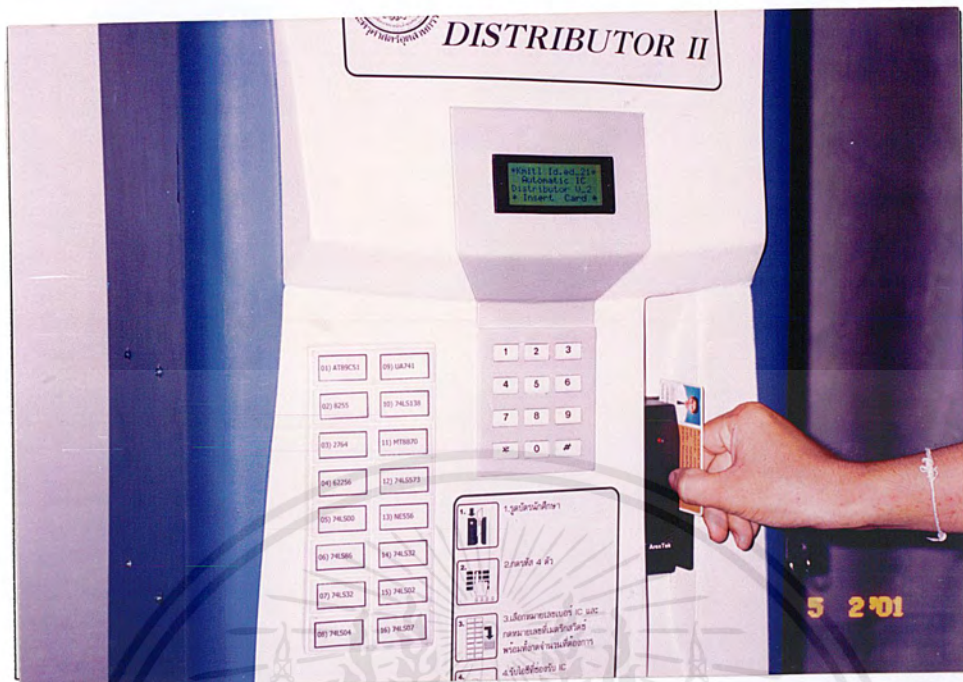
รูปที่ 4.3 การรูดบัตรนักศึกษาจากเครื่องอ่านบาร์โค้ด
