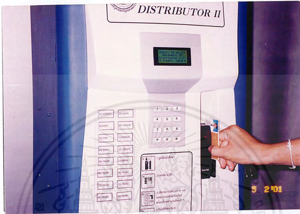
รูปที่ 4.13 ทำการรูดบัตรผู้ควบคุมระบบ
