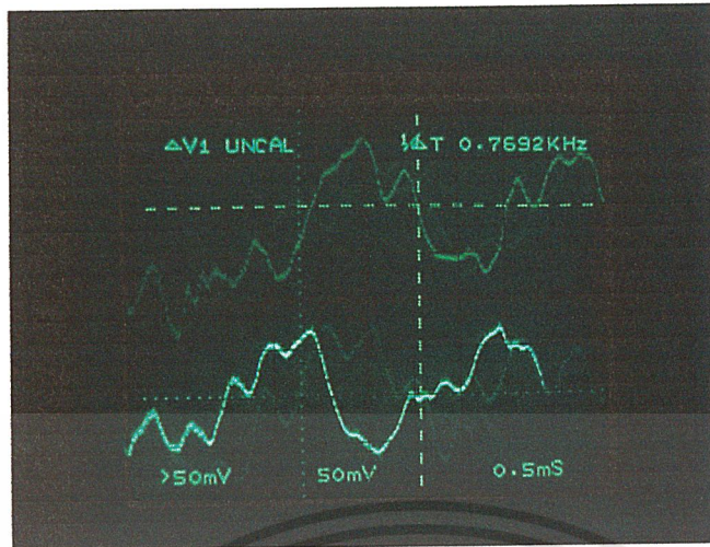
รูปที่ 8-10 สัญญาณเสียงช่องซ้าย (L) และ ขวา(R) ที่ผ่านการติมอูเลตแล้ว
