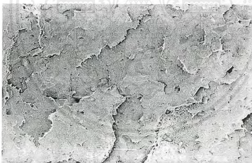
รูปที่ 4.4 แสดงรูป SEM ของ HDPE ที่มี \text{CaCO}_3 ปริมาณ 10 % โดยน้ำหนัก กำลังขยาย 1,000 เท่า
