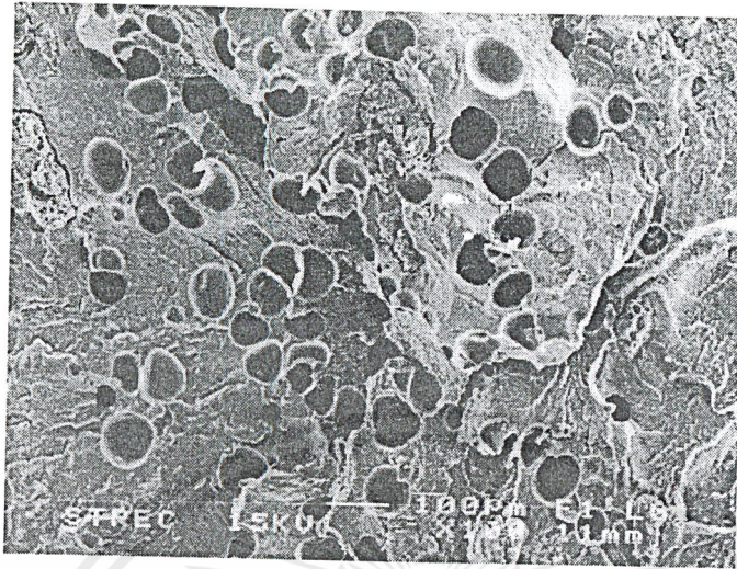
รูปที่ 4.21 แสดงลักษณะการกระจายตัวของฟองอากาศภายในโครงสร้างที่ปริมาณ AZ 2.0 phr กำลังขยาย 100 เท่า
