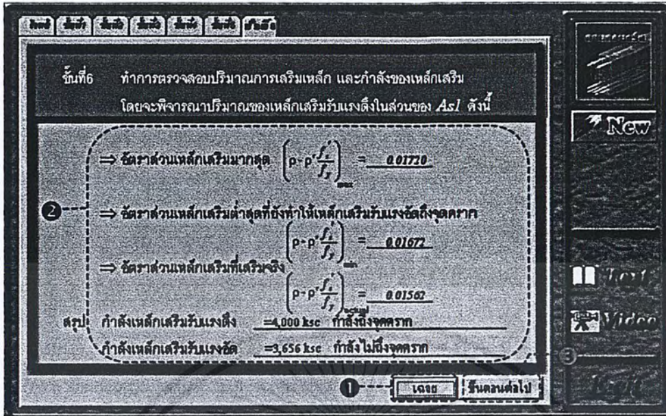
รูปที่ 3. 25 แสดงหน้าต่างการออกแบบในขั้นที่ 6 ของการออกแบบคานคอนกรีตเสริมเหล็กหน้าตัดสี่เหลี่ยมผืนผ้าเสริมทั้งเหล็กรับแรงดึงและเหล็กรับแรงอัด
