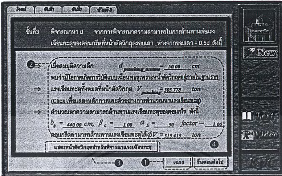
รูปที่ 8.10 แสดงหน้าต่างการออกแบบในขั้นที่3 สำหรับการออกแบบฐานรากคอนกรีตเสริมเหล็ก ประเภทฐานรากเดี่ยววางบนเสาเข็ม
