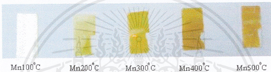
รูปที่ 6.8 แสดงฟิล์มบาง CdS ที่มีการเจือด้วยอะตอมของธาตุ Cu เมื่อที่แอนนีกภายใต้บรรยากาศของก๊าซไนโตรเจนบริสุทธิ์ ที่อุณหภูมิ 100-500 °C เป็นเวลา 20 นาที
