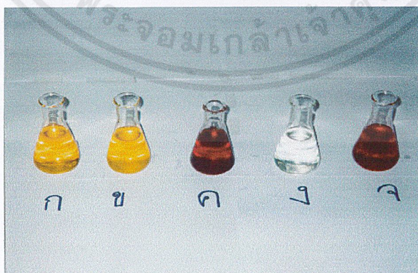
รูปที่ ค.8 เปรียบเทียบลักษณะภายนอกของ ก)น้ำมันปาล์ม ข)ชั้นเอสเทอร์ ค)ชั้นกลีเซอริน ง)เอสเทอร์ที่กลั่นได้ จ)สารที่เหลือจากการกลั่น
