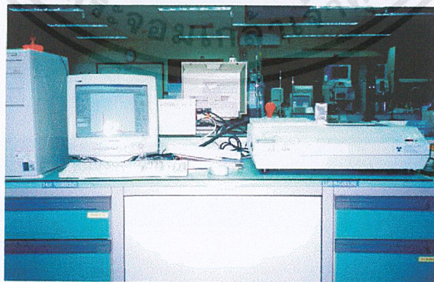
รูปที่ ค.5 เครื่องเอกซเรย์ฟลูออเรสเซนส์เปกโตรมิเตอร์ (X-ray Fluorescence Spectrometer, Jordus Valley Ex310)
