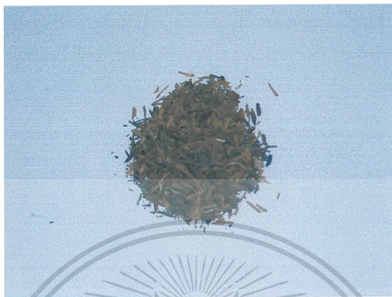
รูปที่ 5-3 ผลที่ได้จากการนำแกลบที่ได้จากโรงสีข้าวมาทำความสะอาดด้วยน้ำดีไอและกรดเกลือจากนั้น อบให้แห้ง
