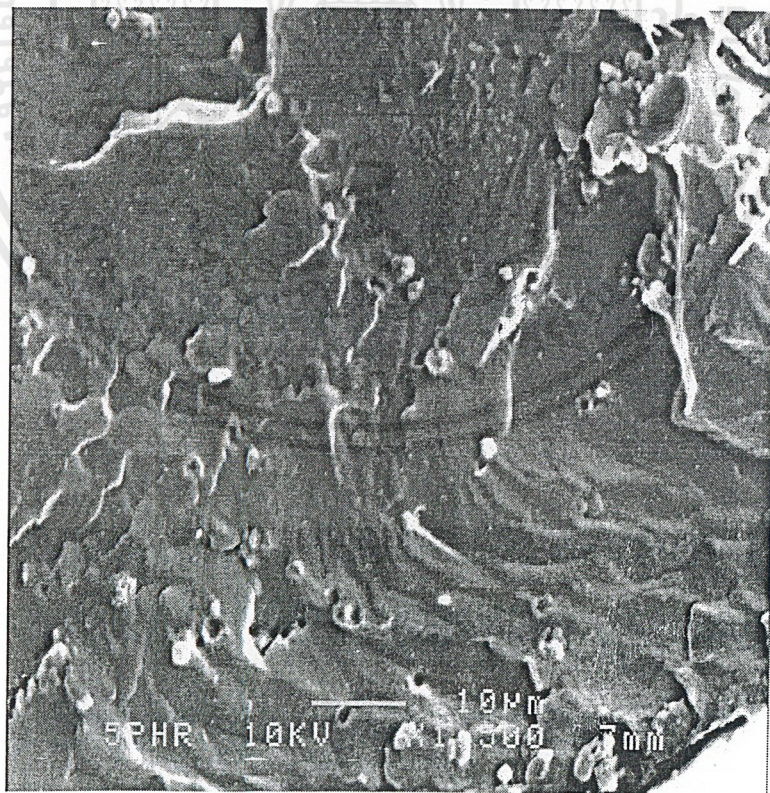
รูปที่ 4.10 สัณฐานวิทยาของ LDPE + Zeolite NaA 5 phr ที่กำลังขยาย 1,500 เท่า
