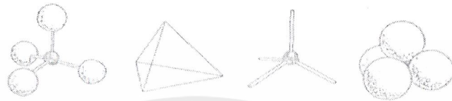
รูปที่ 2.1 ทรงสี่หน้าของอะลูมิเนียม และ ซิลิกา
