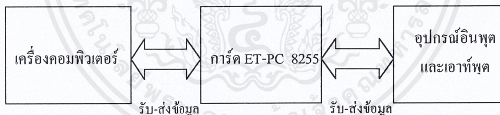
รูปที่ 2.62 บล็อกไดอะแกรมของการติดต่อระหว่างเครื่องคอมพิวเตอร์ และอุปกรณ์อินพุตและเอาต์พุต
