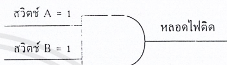
รูปที่ 2.30 หลอดไฟจะติดได้เมื่อสวิทช์ A และ B ติดเท่านั้น
