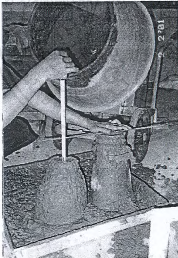
รูปที่ ผ.จ.8. ตัวอย่าง Slump ที่ได้ประมาณ 8 เซนติเมตร
