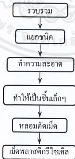
รูปที่ 3.3 ขั้นตอนการผลิตเม็ดพลาสติกรีไซเคิล
