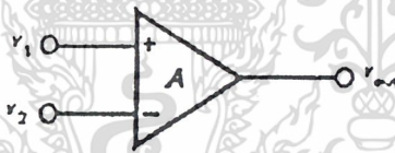
รูปที่ 2.22 แสดงสัญลักษณ์ของออปแอมป์
