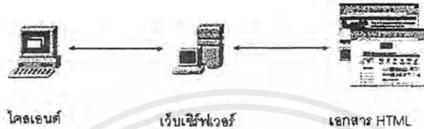
รูปที่ 4.2 การร้องขอเอกสาร HTML จากเซิร์ฟเวอร์คือเมื่อไคลเอนต์ร้องขอกับเซิร์ฟเวอร์ แล้วเซิร์ฟเวอร์จะค้นหาไฟล์ HTML แล้วส่งเอกสารกลับไปให้ไคลเอนต์
