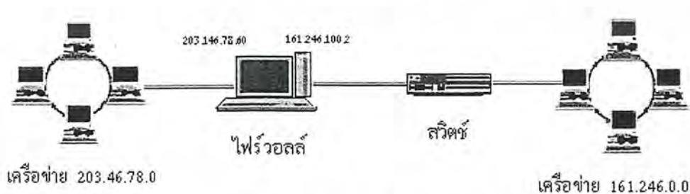
รูปที่ 5-1 แสดงโครงสร้างทางกายภาพของเครือข่ายที่ทดสอบ
