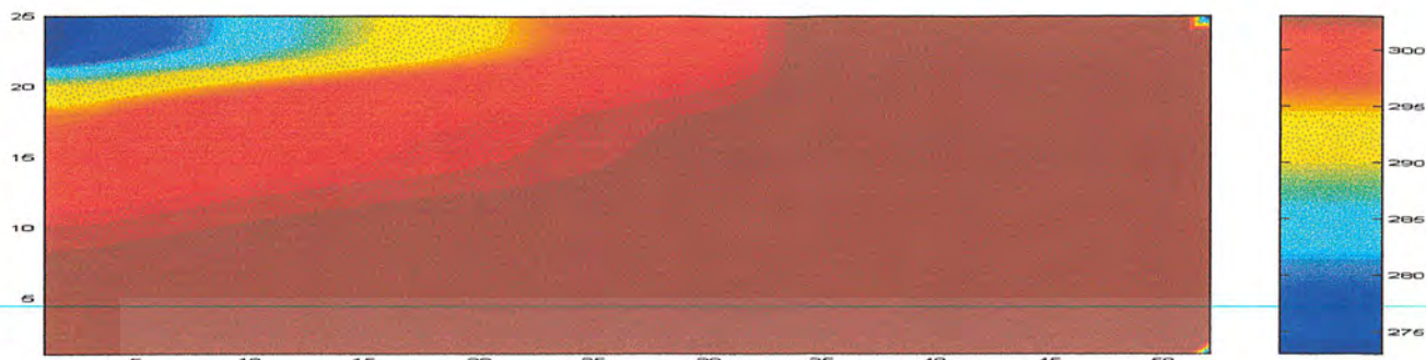
รูปที่ 8.19 การกระจายอุณหภูมิที่เวลา 10 วินาที ( T_{in} 273 K, V_{in} 0.12 m/s)
