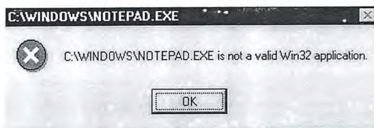
รูปที่ 6-9 ไฟล์ .exe ที่ผ่านขบวนการเข้ารหัสแล้วจะไม่สามารถรันได้
