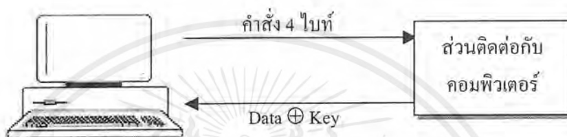
รูปที่ 5-1 การติดต่อระหว่างคอมพิวเตอร์กับส่วนที่ทำการติดต่อกับคอมพิวเตอร์ของฮาร์ดดิสก์
