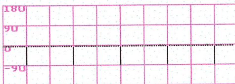
รูปที่ 6.6 รูปสเปกตรัมของสัญญาณรูปคลื่นสี่เหลี่ยมที่มีความถี่ 2.267 kHz และมีขนาด 3 โวลต์
