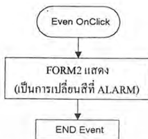
รูปที่ 3.14 แสดง Flow Chart Event OnClick Button เปลี่ยน Color
