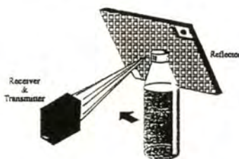
รูปที่ 2.4 แสดงการใช้งานของ เซนเซอร์แบบลำแสงสะท้อนกลับ
