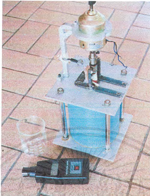
รูปที่ 3.2 ภาพจริงโดยรวมของชุดอุปกรณ์เครื่องวัดความเข้มข้นของน้ำหวาน
