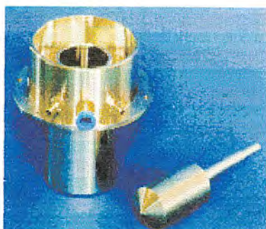
รูปที่ 1.7 เครื่องมือวัดความหนืดแบบ Flow through ชนิดทรงกระบอก
