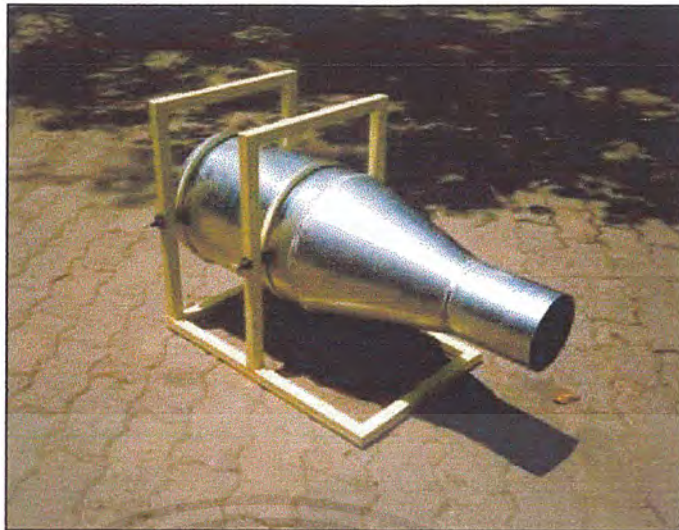
รูปที่ 4.3 รูปประกอบของเรีอนอุโมงค์ (Tunnel), โครงยึด (Frame) และสายรัด (Strap)
