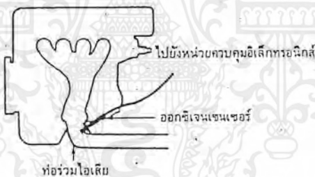
รูปที่ 2.34 ตำแหน่งติดตั้งออกซิเจนเซนเซอร์
