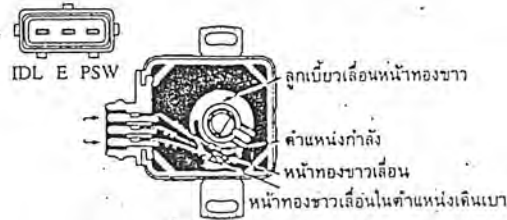
รูปที่ 2.22 ส่วนประกอบของเซนเซอร์ตำแหน่งลิ้นเร่ง
