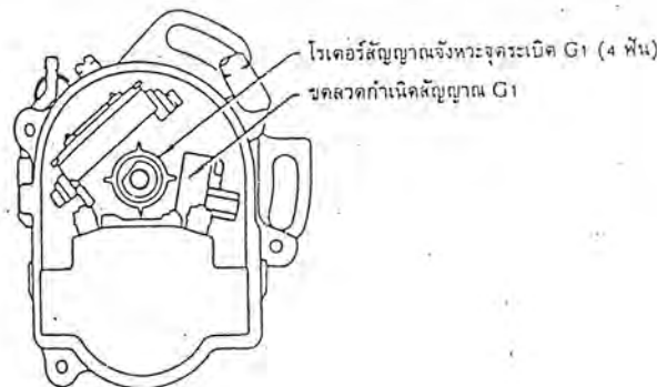
รูปที่ 2.30 โรเตอร์สัญญาณและขดลวดกำเนิดสัญญาณ
