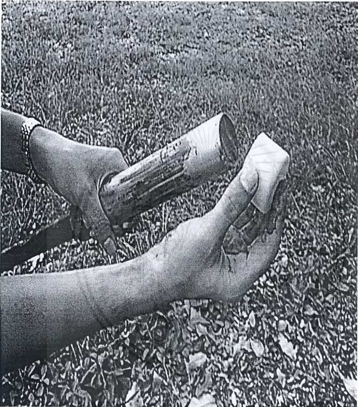
รูปที่ ผ.จ. 7 แสดงตัวอย่างดินที่เก็บออกมาจากหลุมเจาะ
