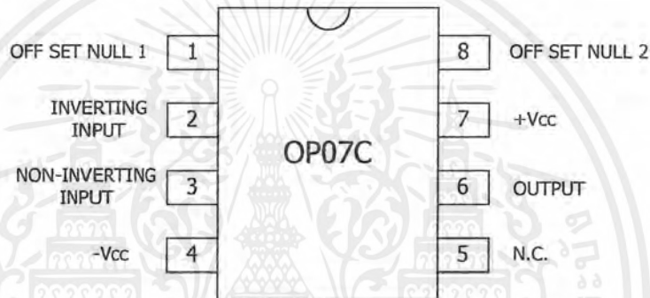
รูปที่ 3.12 รายละเอียดไอซีออปแอมป์ OP07
