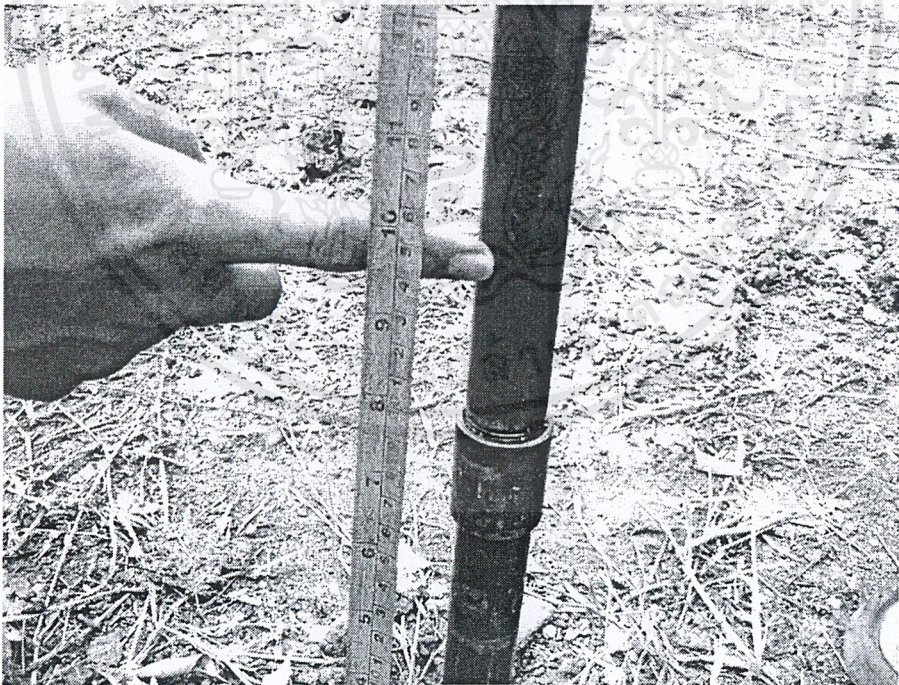
รูปที่ ผ.จ.4. แสดงการวัดระยะที่จะกดก้านกดเพื่อให้ดินเต็มกระบอกพอดี
