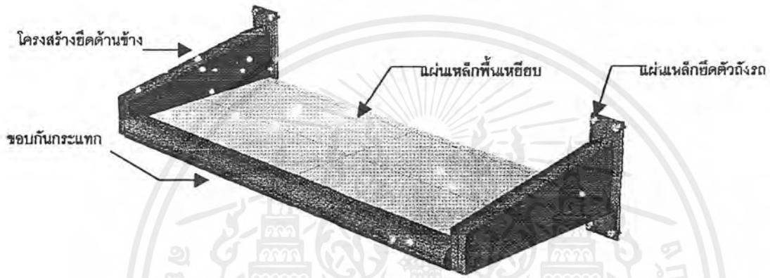
ภาพประกอบที่ 2.5.5.7 โครงสร้างส่วนประกอบบันไดพักเท้า
