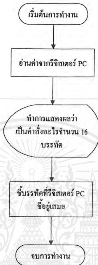
รูปที่ 3.7 แสดงการทำงานของคำสั่ง Disassemble Window
