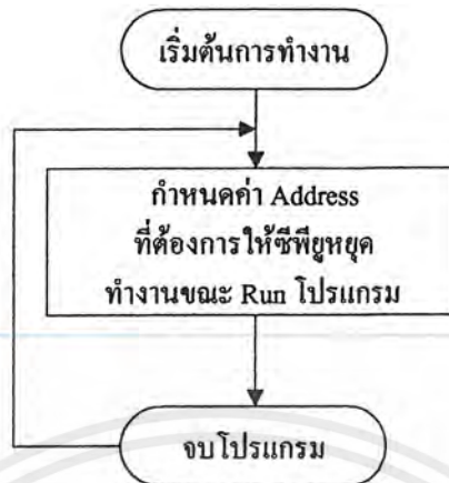
รูปที่ 3.11 แสดงการทำงานของคำสั่ง Set Breakpoint
