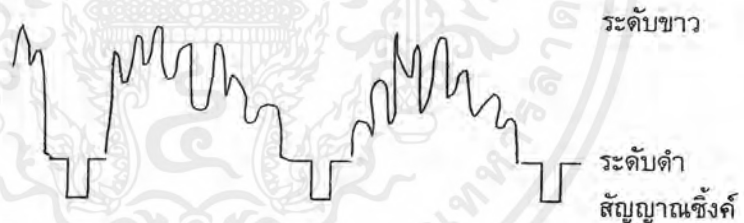
รูปที่ 14 สัญญาณภาพ , แบล็กคิงและซิงค์ทางแนวนอน
