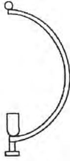
รูปที่ 29 โครงรับโປ้ไฟแบบโครง 1 เส้น
