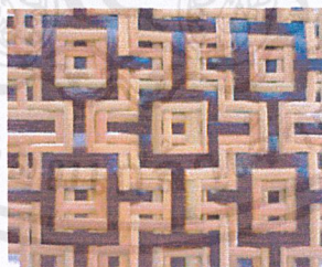
ภาพที่ 368 แสดงตัวอย่างการสานร่วมระหว่างแผ่นปิดผิวเฟอร์นิเจอร์ กับ คล้ำ
