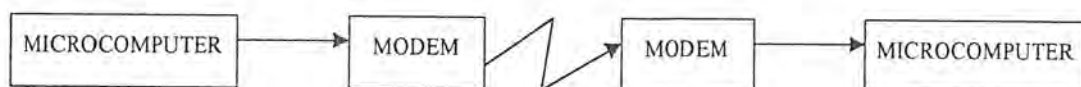
รูปที่ 2.17 แสดงการใช้ RS232C เชื่อมต่ออุปกรณ์
