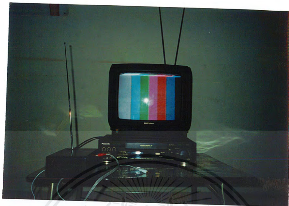
รูปที่ 4.7 แสดงภาพถ่ายสัญญาณ Color Bar จากเครื่องส่งสัญญาณวิดีโอที่รับได้ที่เครื่องรับโทรทัศน์
