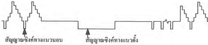
ก. สัญญาณภาพรวม แสดงให้เห็นสัญญาณภาพกับสัญญาณวงรีในแนวนอน และสัญญาณซิงค์ทางแนวตั้ง
