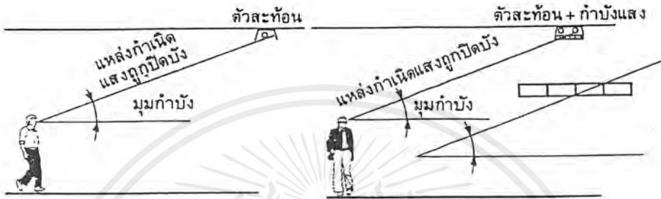
รูปที่ 2.7 การควบคุมแสงจ้าโดยมุมกำบัง
