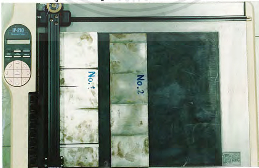
รูปที่ 4.2 ฟลोटเตอร์ และลักษณะของการวางชิ้นงานที่ใช้ในการตรวจสอบ
