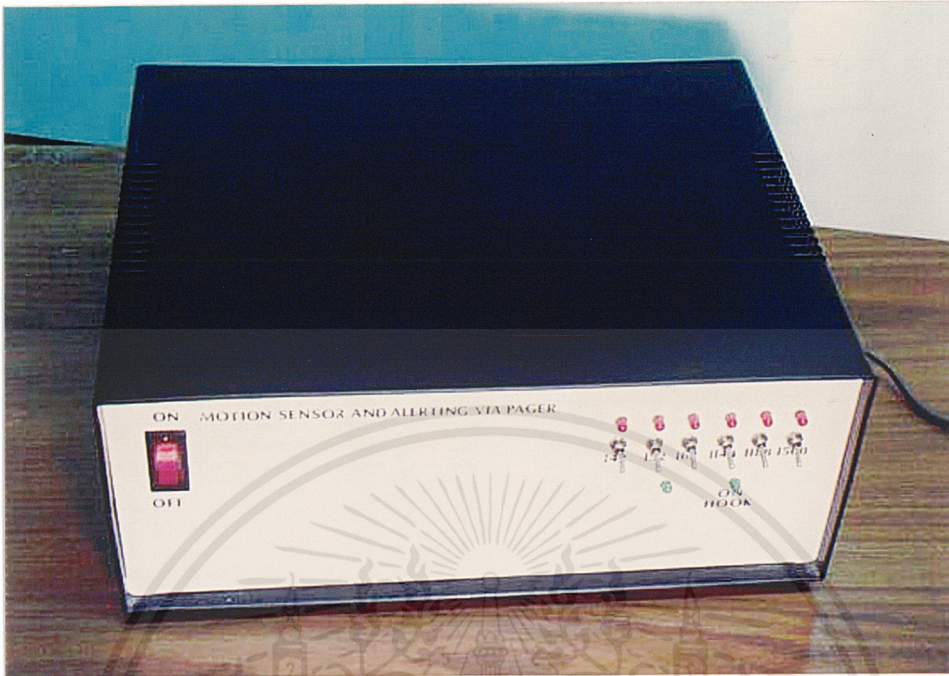
รูปที่ ก.1 เครื่องระบบตรวจจับความเคลื่อนไหวและแจ้งเหตุผ่านเพจเจอร์
