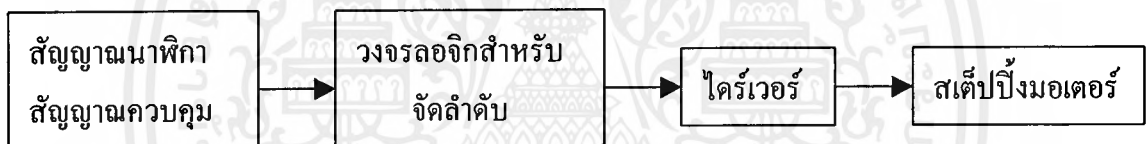
รูปที่ 2.2 ไดอะแกรมการควบคุมสเต็ปปีงมอเตอร์
