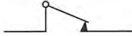
รูปที่ 2.2 สัญลักษณ์ของรีเลย์หน้าสัมผัสแบบ B
