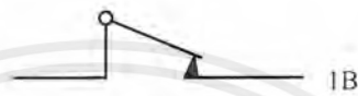
รูปที่ 2.5 รีเลย์แบบ B ที่มีจำนวนหน้าสัมผัส 1 ชุด
