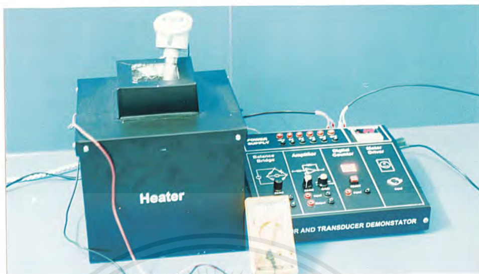
รูปที่ 4.8 การต่อแผงทดลองการทำงานของเทอร์โมคัปเปิล
