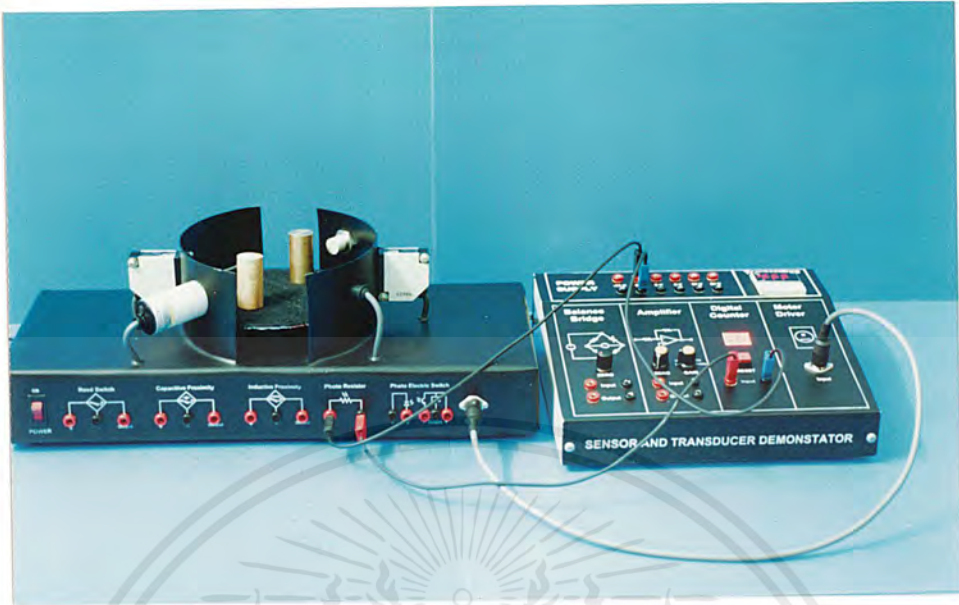
รูปที่ 4.5 การต่อแผงทดลองการทำงานของ Photo Resistor
