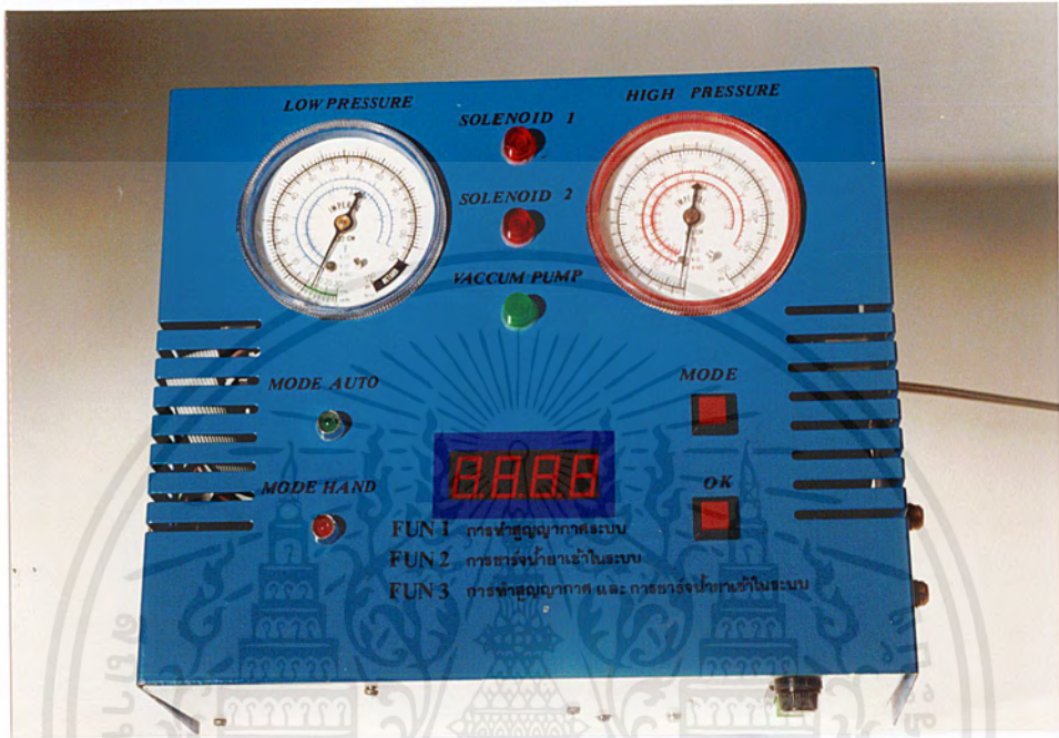
รูปที่ ก.1 เครื่องต้นแบบระบบบำรุงรักษาเครื่องปรับอากาศ
