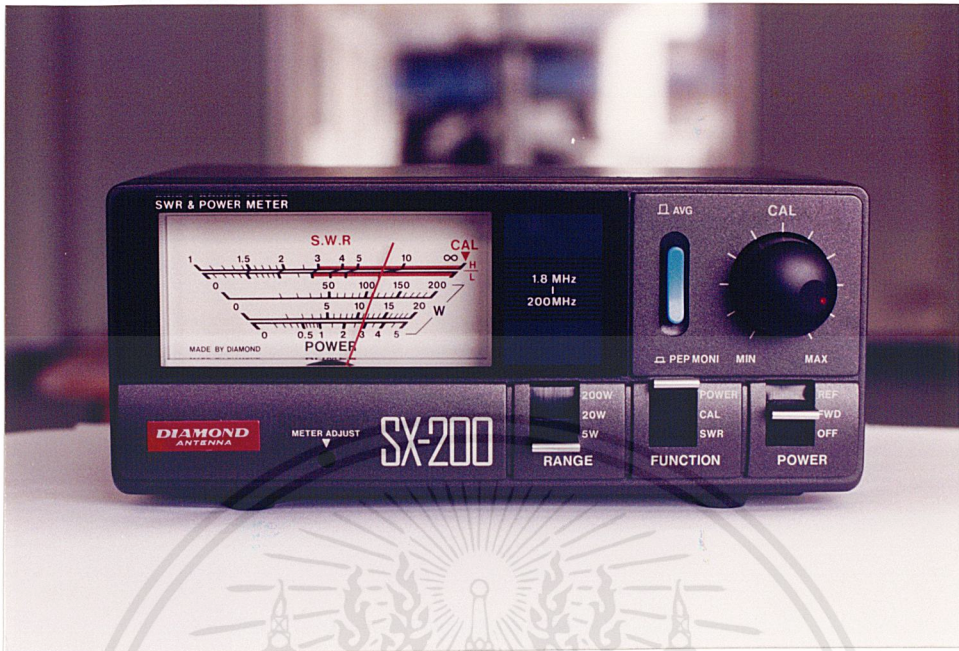
รูปที่ 4.17 ค่ากำลังส่งที่วัดได้จากสายอากาศรับเบอร์ดัก โดยใช้เครื่องวัดเอสดับบลิวอาร์ ยี่ห้อ Diamond รุ่น SX-200
