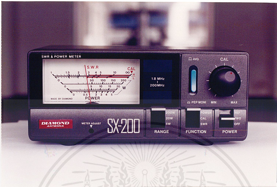
รูปที่ 4.7 ค่ากำลังส่งที่วัดได้จากสายอากาศซีโพลด โดยใช้เครื่องวัดเอสดับบลิวอาร์ยี่ห้อ Diamond รุ่น SX-200
